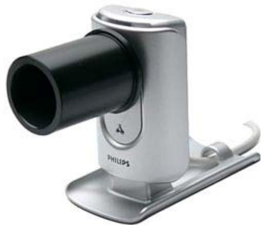
La webcam Philips Toucam Pro II (ormai fuori produzione) pronta per le riprese planetarie: si è svitato l'obiettivo e si è inserito un adattatore per il porta oculare del telescopio
