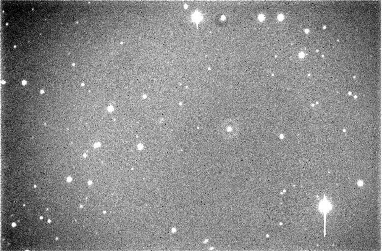
Tipica ripresa al fuoco di uno SCT con riduttore di focale: la perdita di luce ai bordi è ben visibile. Se essa non è totale basta un buon flat field per correggerla
